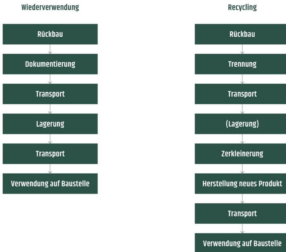
Abbildung 24: Ablaufprozess Wiederverwendung und Recycling
